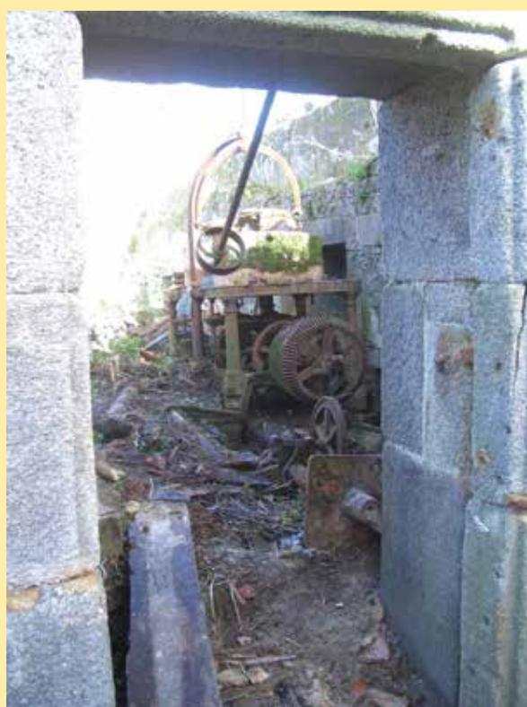
Figuras 40, 41 - Imagens do início de obra em 2002. Podemos observar, à esquerda, serra de fita e veio de transmissão com tambores e à direita, banca de moagem e no chão, distribuidor das pás diretrizes da turbina.
